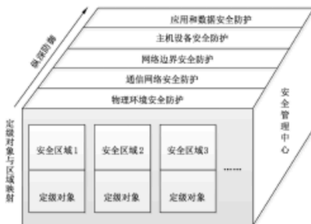
图 4 等级保护对象的安全技术体系架构
